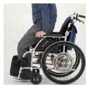
乗車者が駐車ブレーキをかけ忘れて車いすから立ち上がった場合、自動で安全ブレーキが車いすの駆動輪を動かさないようにロックします。
